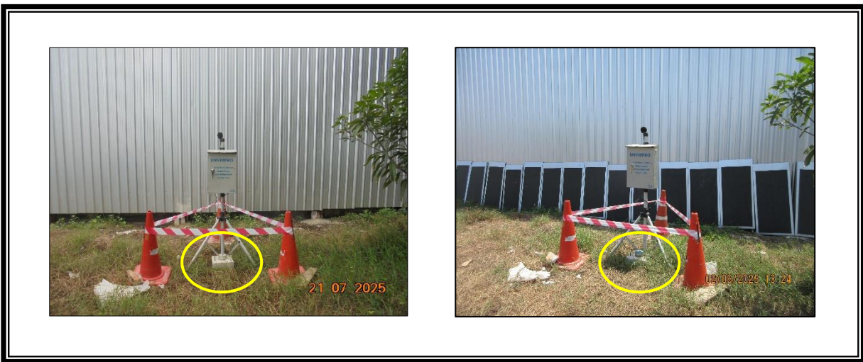
รูปที่ 3.3-1 จุดตรวจวัดความสั่นสะเทือน บริเวณภายในพื้นที่รื้อถอน
